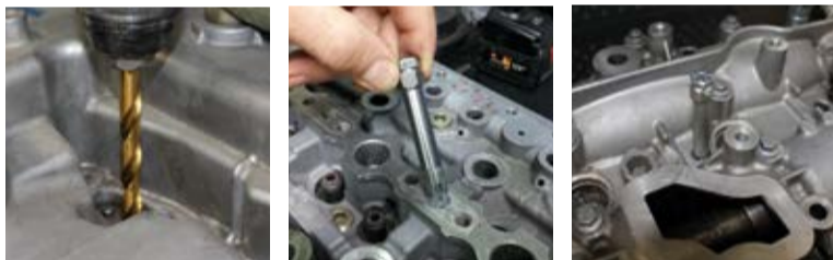
Punta especial Ø9 mm - tapa de la válvula montada
