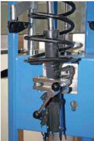
Amortiguador fijado en la abrazadera
