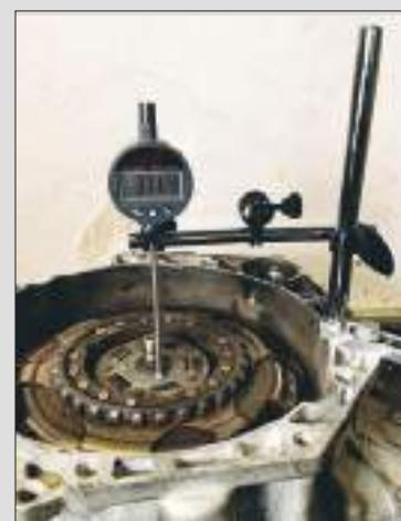
Prueba de juego vertical con extensión del sensor
