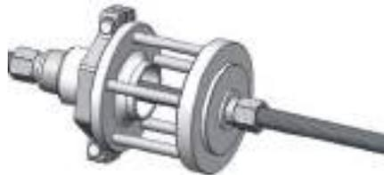
**2** Desmontaje abrazadera interna del rodamiento del cubo rueda
