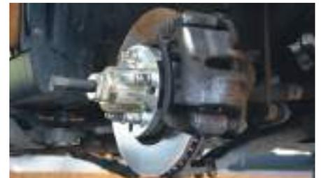
Extracción del eje de transmisión con un tornillo hidromecánico de 16 toneladas (opcional)
