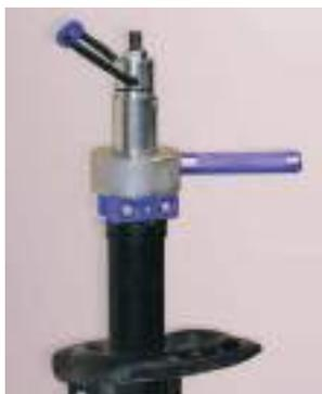
Atornille el extractor del vástago en el soporte y coloque la unidad en el vástago del amortiguador. Fije el vástago del amortiguador al extractor de vástagos con la tuerca de seguridad.
