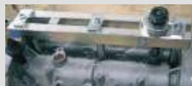
Extracción con cilindro mecádráulico 12TON
