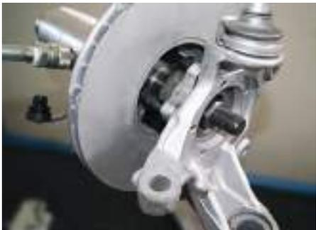
Desmontaje cubo de la rueda con disco del freno - **cambio rodamiento de la rueda**
