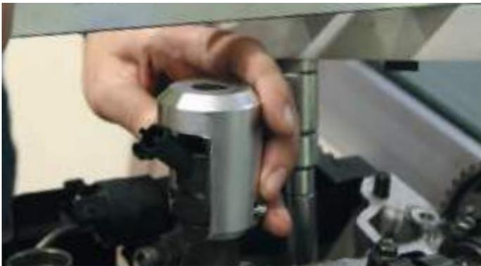
Coloque el casquillo en el inyector, sujetándolo por debajo de la tuerca. Si es necesario, desenrosque ligeramente la tuerca de fijación con el objetivo de crear el espacio necesario para colocar la herramienta.
