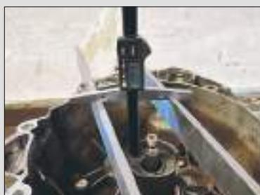
Medición de la profundidad de montaje K2 (Atención: el calibrador mostrado no está incluido en el suministro)
