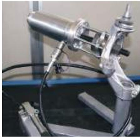
Desmontaje rodamiento de la rueda en el vehículo - **cambio rodamiento de la rueda**
