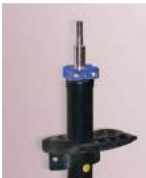
Coloque la abrazadera con los tornillos de fijación. No apriete.
