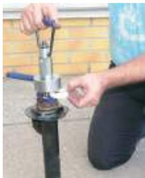
Si el carrera del extractor de vástagos es insuficiente: inserte uno o los dos espaciadores suministrados entre el soporte y la abrazadera, para que el vástago del amortiguador pueda salir más.
