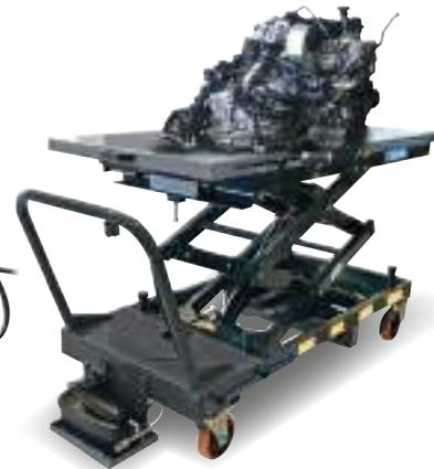
Adecuado para todo tipo de baterías que pesen 1500 kg o menos y otros componentes del automóvil.
