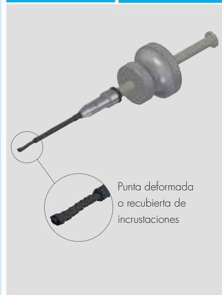
Punta deformada o recubierta de incrustaciones
