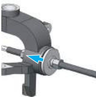
**4** Montaje del nuevo rodamiento de la rueda del radio del eje
