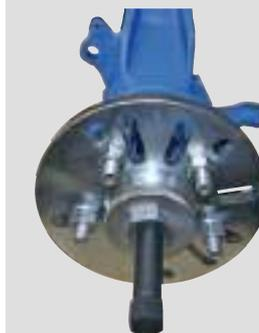
Extracción eje de transmisión del cubo
