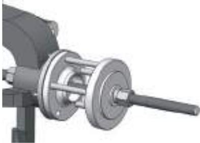
**1** Desmontaje del cubo rueda
