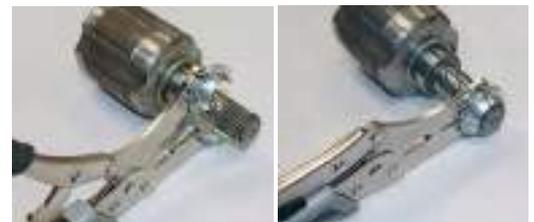
Los alicates deslizan automáticamente hacia abajo cuando la junta se abre. Ideal para recuperar el eje de transmisión sin riesgo de hacerle daño y tener que sustituirlo completamente.
