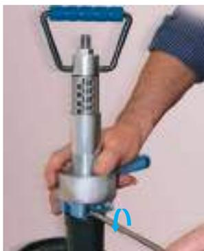
Una vez terminada la extracción, fije la abrazadera con los tornillos correspondientes.
