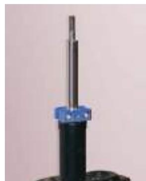
Después de bloquear la abrazadera en su configuración final, retire el extractor de vástagos. Proceda al montaje del muelle y retire la abrazadera.
