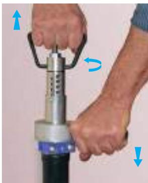
Tire el extractor por cuanto posible manualmente y bloquéelo con los dientes posicionados a la izquierda o a la derecha; es posible extraer 20mm adicionales de vástago sin esfuerzo atornillando el útil.
