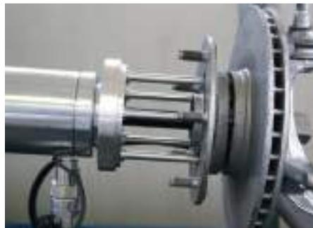
Separar el disco de freno en el vehículo - **cambio disco del freno**
