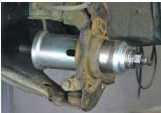
**Montaje cubo = a través de presión en anillo interno del rodamiento.**
